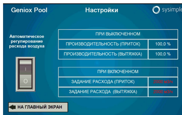
Рис. 6 – пример интерфейса раздела «Настройки» сенсорной панели
