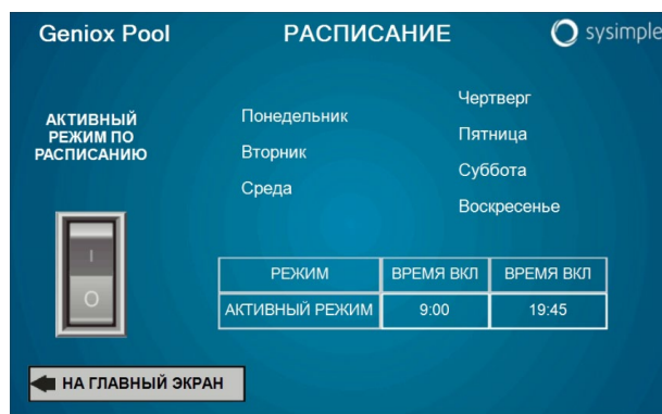
Рис. 8 – пример интерфейса раздела «Расписание» сенсорной панели
