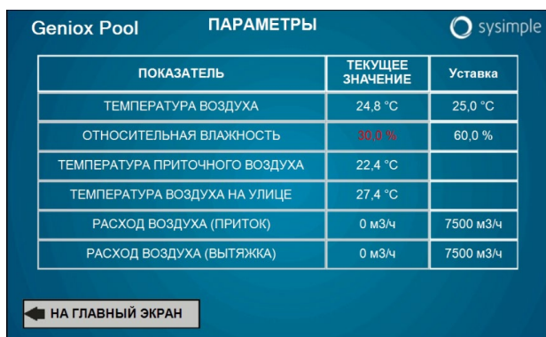
Рис. 7 – пример интерфейса раздела «Параметры» сенсорной панели
