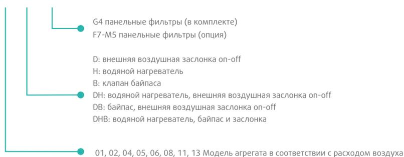
**Клапан байпаса:** воздухообрабатывающие агрегаты SysReco FX доступны к заказу с секцией 100% байпаса. Клапан направляет приточный воздух через байпас в теплое время года (когда рекуперация не требуется) и в холодное время года при возникновении опасности замерзания. Для реализации функции байпаса необходима встроенная система автоматики. Если вы выбрали опцию с байпасом, то агрегат будет укомплектован электроприводом и кабелем для подключения к системе автоматики.
