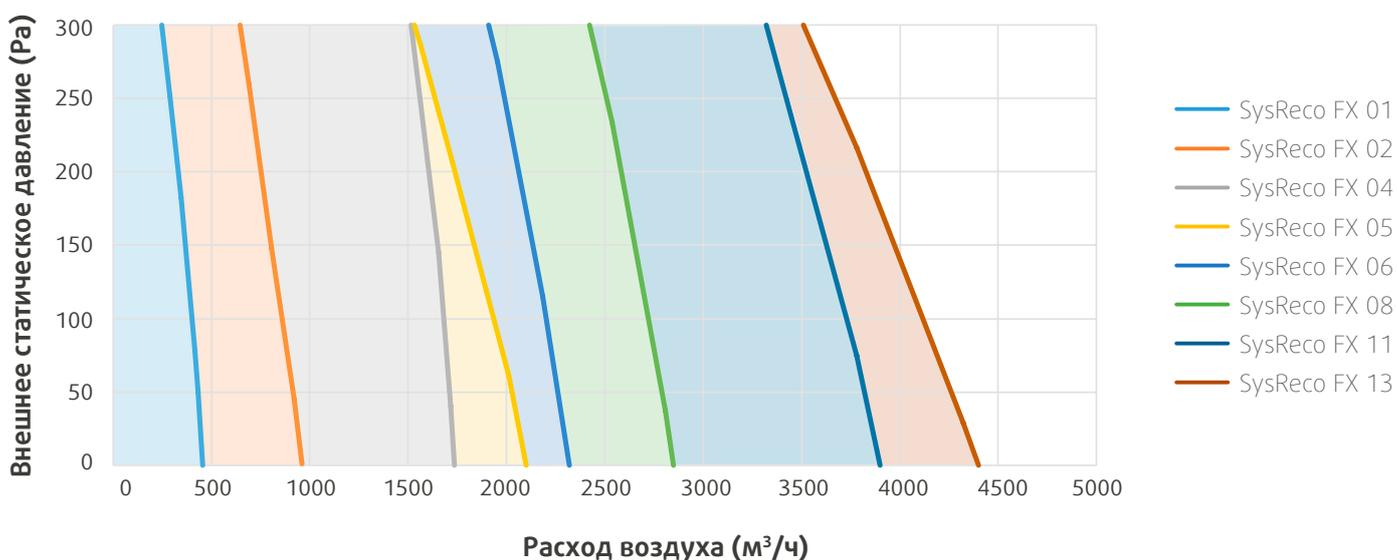
\*Результаты испытаний актуальны при условии использования чистых фильтров с классом эффективности F7 в установке с водяным догревателем.
