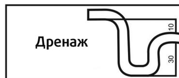
Перед запуском агрегата SAVE VP следует подключить дренажные трубы к канализации. Диаметр дренажной трубы 19 мм.
