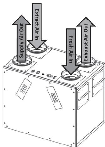
Подключения воздушных патрубков должны выполняться с помощью металлического воздуховода, соответствующего диаметру модели SAVE VP (Ø160 / Ø180 мм).
