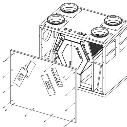
2. При закрытии крышки туго закрутите винты.
