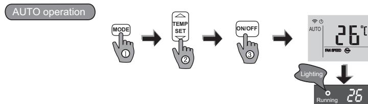
При выборе Автоматического режима работы (AUTO), кондиционер самостоятельно устанавливает режим работы: охлаждение, обогрев, или только вентиляция в зависимости от выбранной вами температуры и температуры в помещении. Установленный вами режим работы фиксируется в памяти микрокомпьютера внутреннего блока, поэтому при повторном включении кондиционера, прибор начинает работать с ранее установленными настройками.
