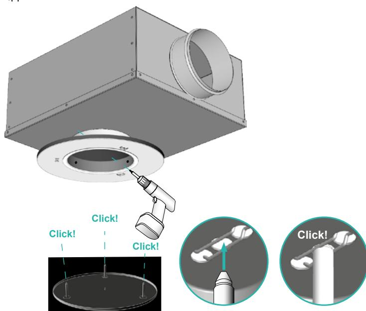
**Установка диффузора к гибкому воздуховоду с помощью саморезов**
