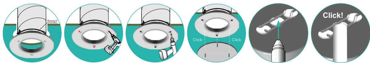
**Монтаж диффузора к гибкому воздуховоду с помощью монтажных скоб**
