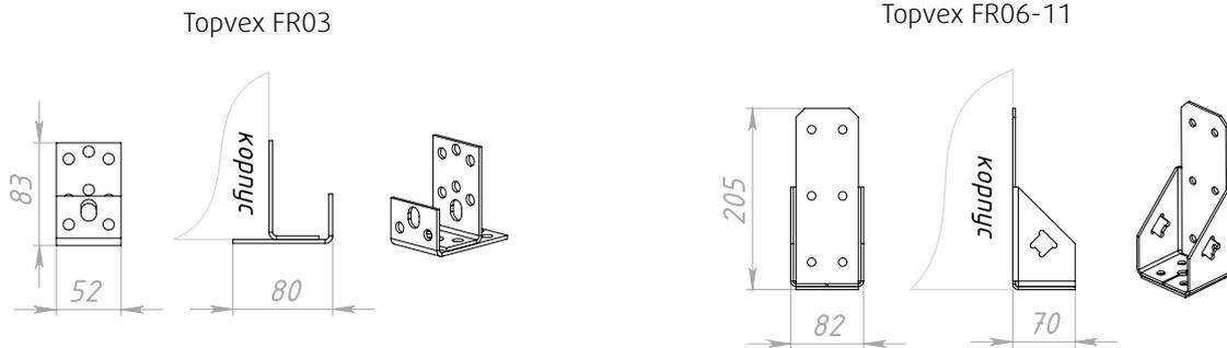
Для напольного монтажа доступны опорные ножки (доп. опция):
